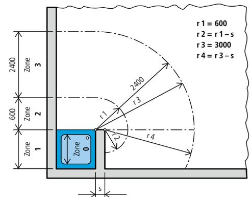
Le chauffe-eau instantané de l'équipement de douche CEI 5.7 kW est conforme à la classe de protection IP 25 et peut donc être installé dans la zone de protection 1 selon VDE 0100, Partie 701.
