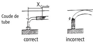
En cas de pose coudée, la longueur du tuyau doit être suffisante pour former un coude ouvert, sinon le tuyau sera plié au niveau des raccords et se cassera.
