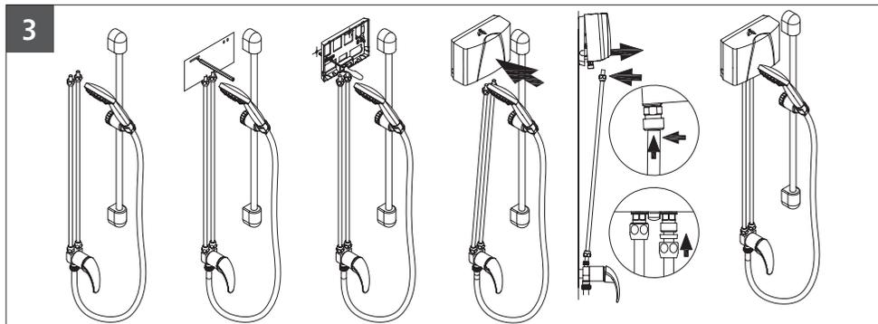
1. Commencer par visser la pièce de robinetterie spéciale munie de la rosace de protection à un raccord d'eau de  $\frac{1}{2}$  pouce sur une plaque murale et réaliser l'étanchéité avec un produit d'étanchéité approprié. Les deux raccords d'eau de  $\frac{3}{8}$  pouce doivent être orientés verticalement vers le haut.
